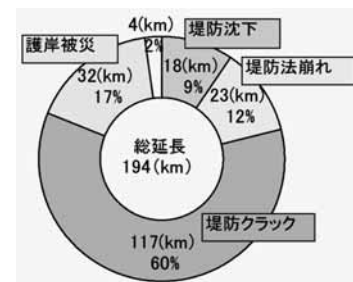
図-3 堤防の地震による被災内容
