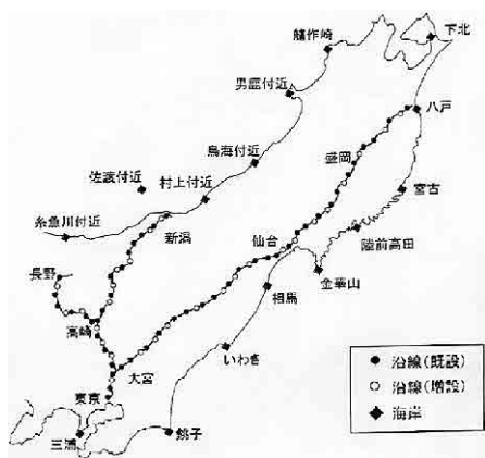
図-1 東北新幹線の沿線地震計設置箇所 設置間隔は最大で20km、平均13km (東日本旅客鉄道、『二度の震災から学んだ記録』から引用)
